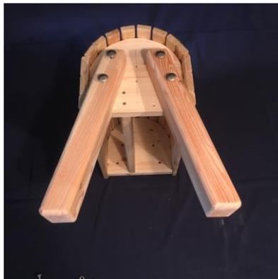
Die Beine werden von außen, mit der Nummerierung nach innen, an den Körper montiert. Zum Montieren der Beine benutzen sie die 4 Schrauben M10x100, 4 Schrauben M10x110. Die kürzeren Schrauben gehören an die Oberseite des Beines.
