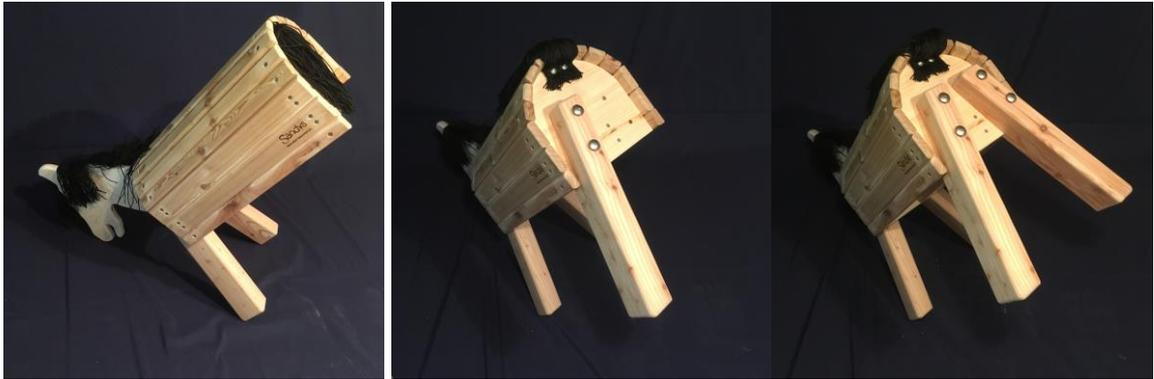
5. Richten sie das Pferd auf und kontrollieren es auf Standfestigkeit. Vor dem Festziehen der Schrauben an den Beinen müssen alle Beine ausgerichtet werden, so dass das Pferd nicht kippelt. Dann ziehen Sie die Schrauben fest.
